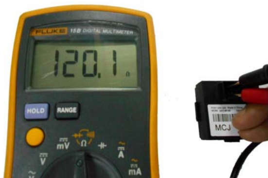
شکل 2-7 روش اندازه گیری مقاومت شبکه های CAN
