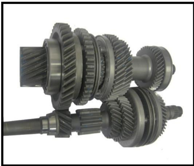
شکل ۴۲ : نحوه‌ی قرارگیری شفت ورودی و خروجی کنار هم
