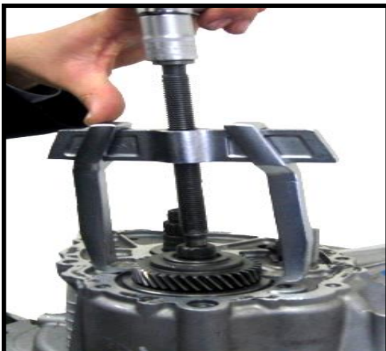
شکل ۱۶ : خارج کردن چرخ‌دنده دنده ۵
