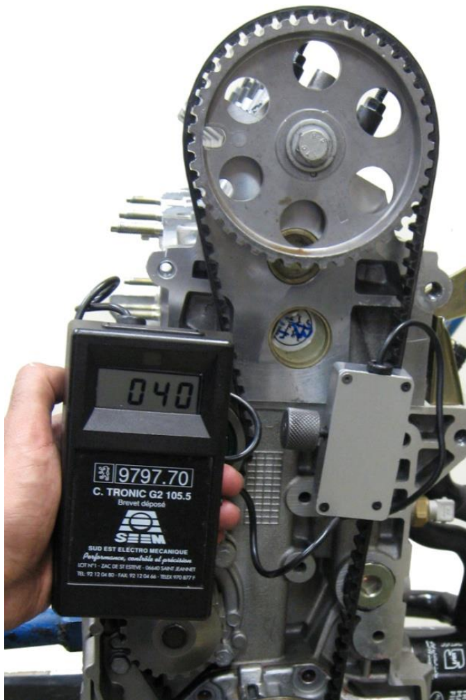
اندازه گیری کشش تسمه توسط دستگاه Tensiometer
