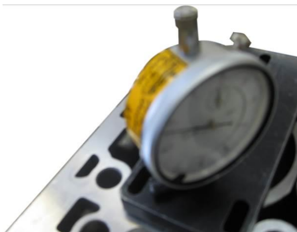
نمایی از صفحه، پایه و ساعت اندیکاتور و نحوه قرار گیری آن بر روی بلوکه سیلندر
