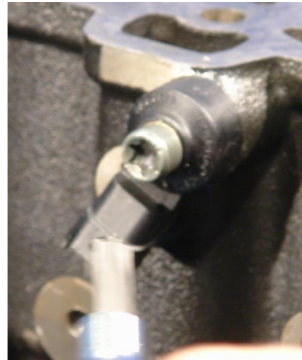
26- پیچ‌های صفحه نگه‌دارنده کاسه نمد عقب میل لنگ را به ترتیب قید شده در شکل، ابتدا شل نموده و سپس اقدام به باز نمودن آنها نمایید. (6 عدد پیچ) (آچار بکس E10)
