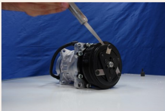
نحوه فیلرگیری توسط این ابزار، می توان فاصله هوایی بین صفحه کلاچ و پولی را اندازه گیری و تنظیم کرد
