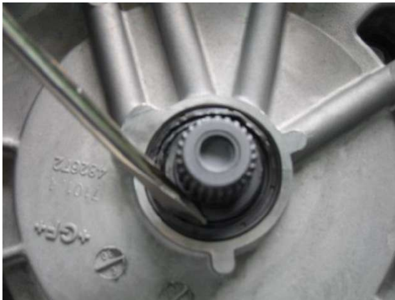
Fig. 3-1: Remove input shaft seal
