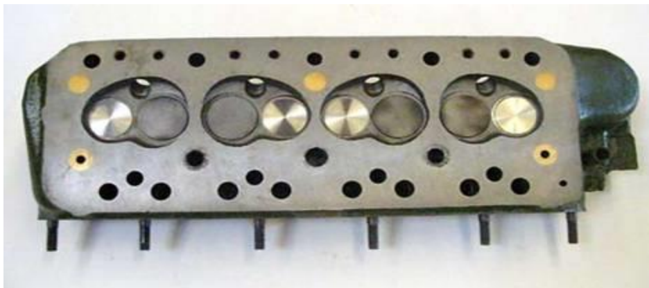
نمای سر سیلندر از جهت تماس با سیلندر
