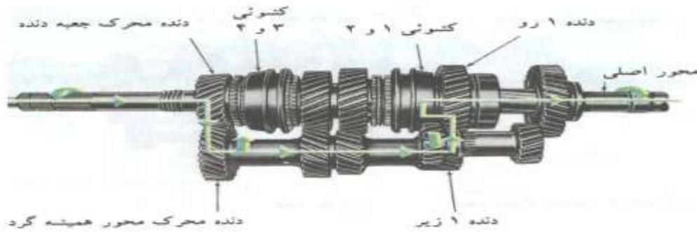
شکل ۳۸ - حالت دنده ۱ با حرکت کنشونی بطرف دنده ۲
