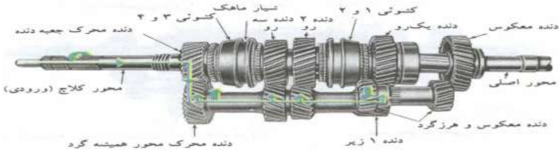
مراحل تعویض دنده یک جعبه تمام سنکروتیزه چهار سرعته
