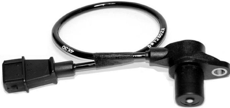
شکل ۱-۱۲۷- ساختمان ظاهری سنسور موقعیت میل لنگ و دور موتور
