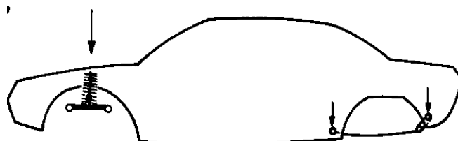
شکل 4-28: فنر شمش طولی در عقب خودرو، کف صندوق بار را تقویت می‌کند، با این حسن که بدنه خودرو کمتر بارگذاری می‌شود.
