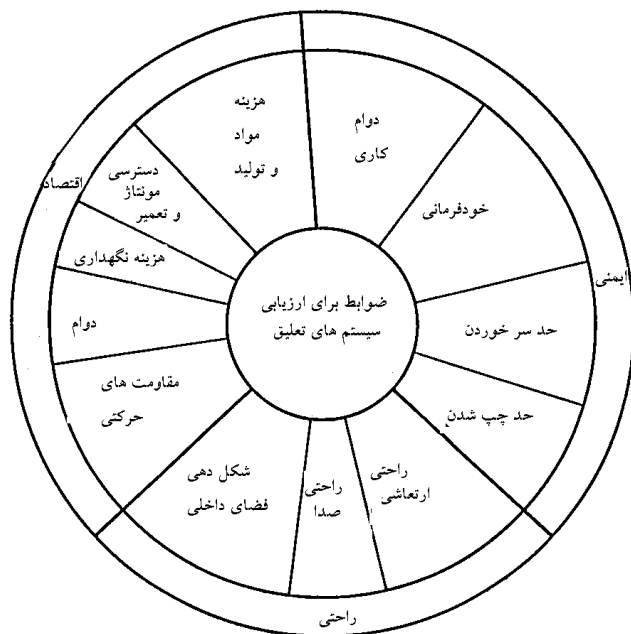
شکل 3-1: ضوابط ارزیابی سیستم‌های تعلیق چرخ خودروها. بزرگی سطوح قطاع تابع اهمیت ضوابط است.
