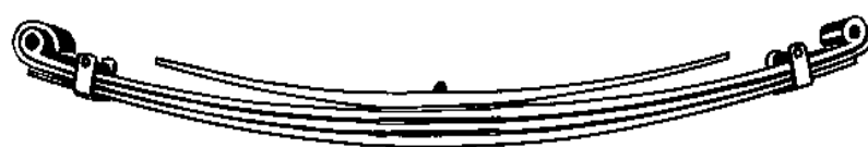
شکل 3-43: فنرهای سهمی شکل بکار رفته در کامیونها با اتصال مرکزی مشخصات جدول 3-6
