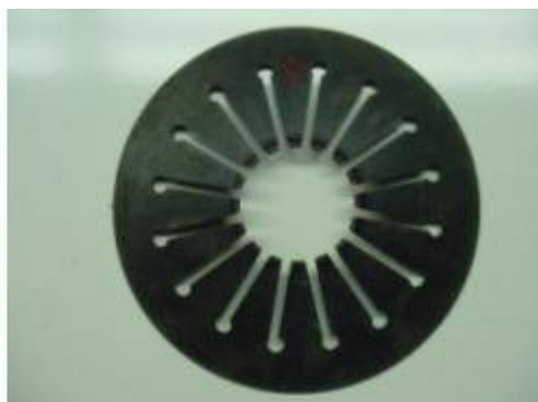
فنر دیافراگمی و نمونه ای از کلاچ دیافراگمی
