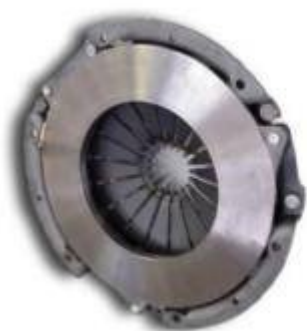
فنر دیافراگمی و نمونه ای از کلاچ دیافراگمی
