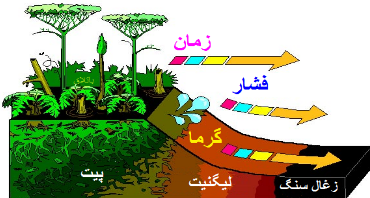
شکل ۱۶,۱ نحوه تشکیل زغال سنگ
