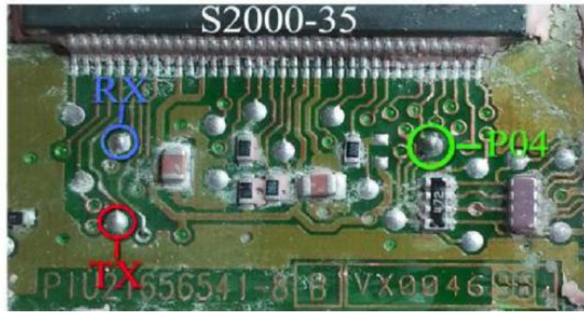
محل اتصالات ساژم ۲۰۰۰ روی رزین
