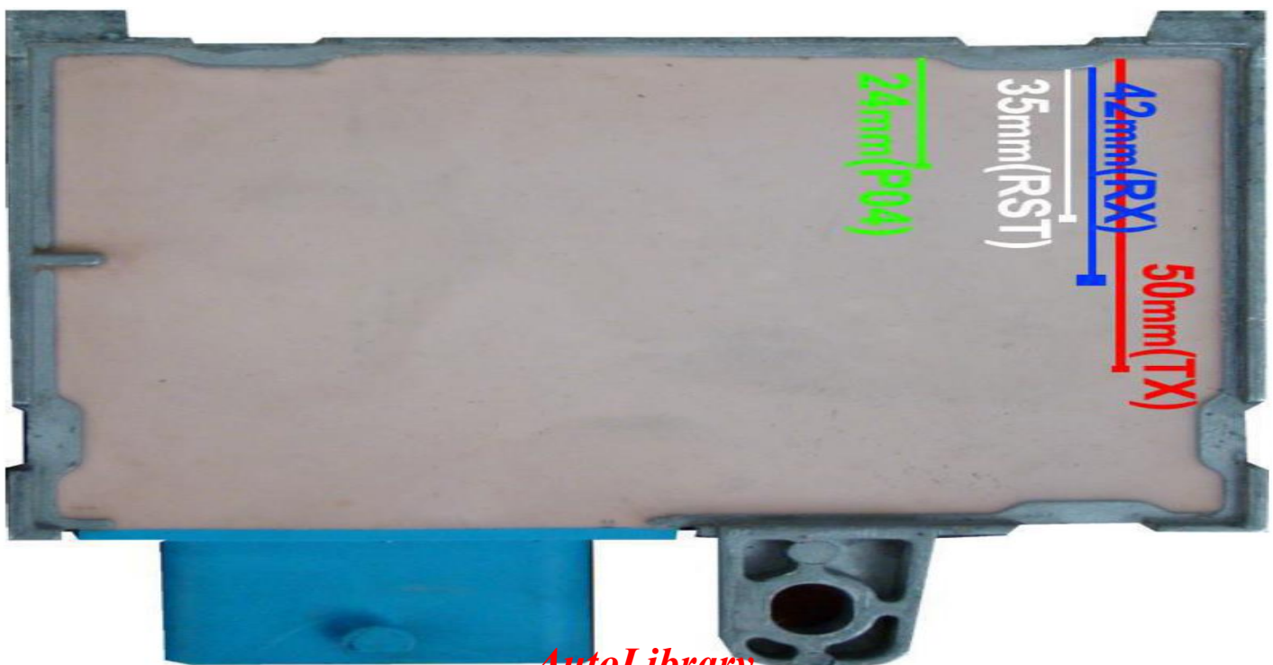
محل اتصالات Sax 500 از روی رزین
