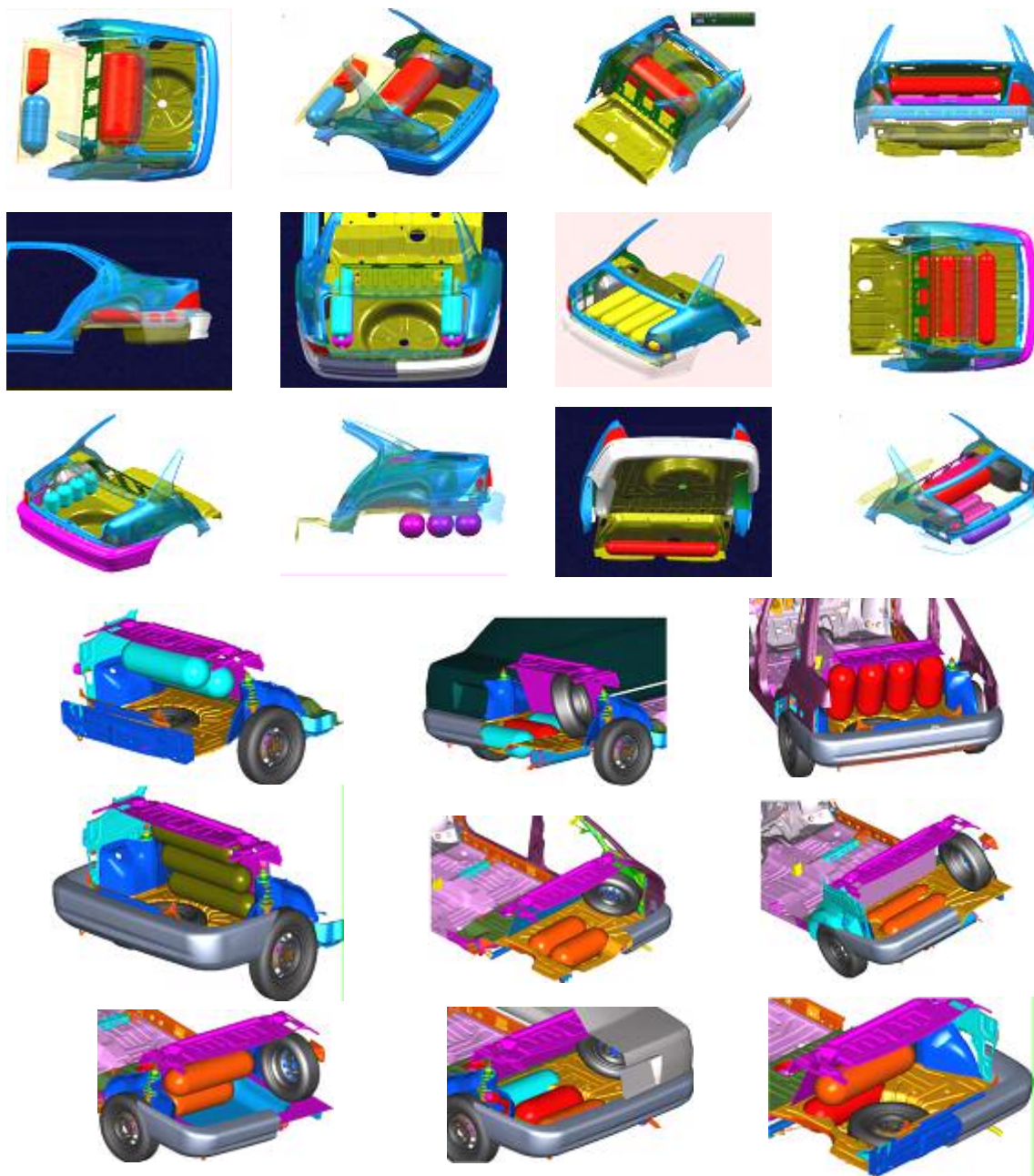
شکل ۴-۱: جانمایی مخازن در خودروی پراید
