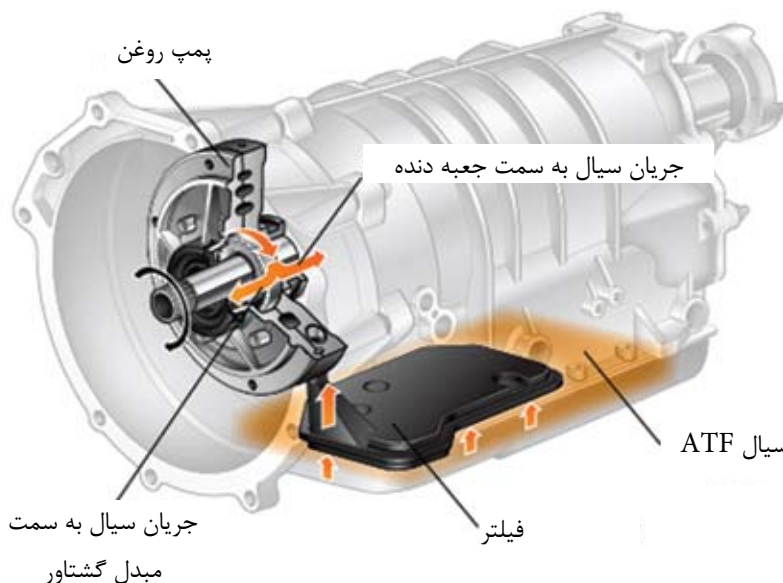
شکل ۲. مسیر سیال انتقال نیروی اتوماتیک
