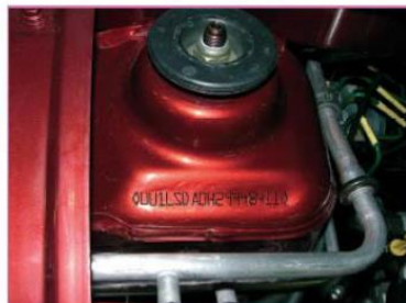
شماره شناسایی خودرو (VIN) روی داشبورد و روی قطعه اتصال کمک فنر حک می شود.
