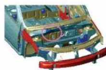
شماره شناسایی خودرو (VIN) روی داشبورد و روی قطعه اتصال کمک فنر حک می شود.
