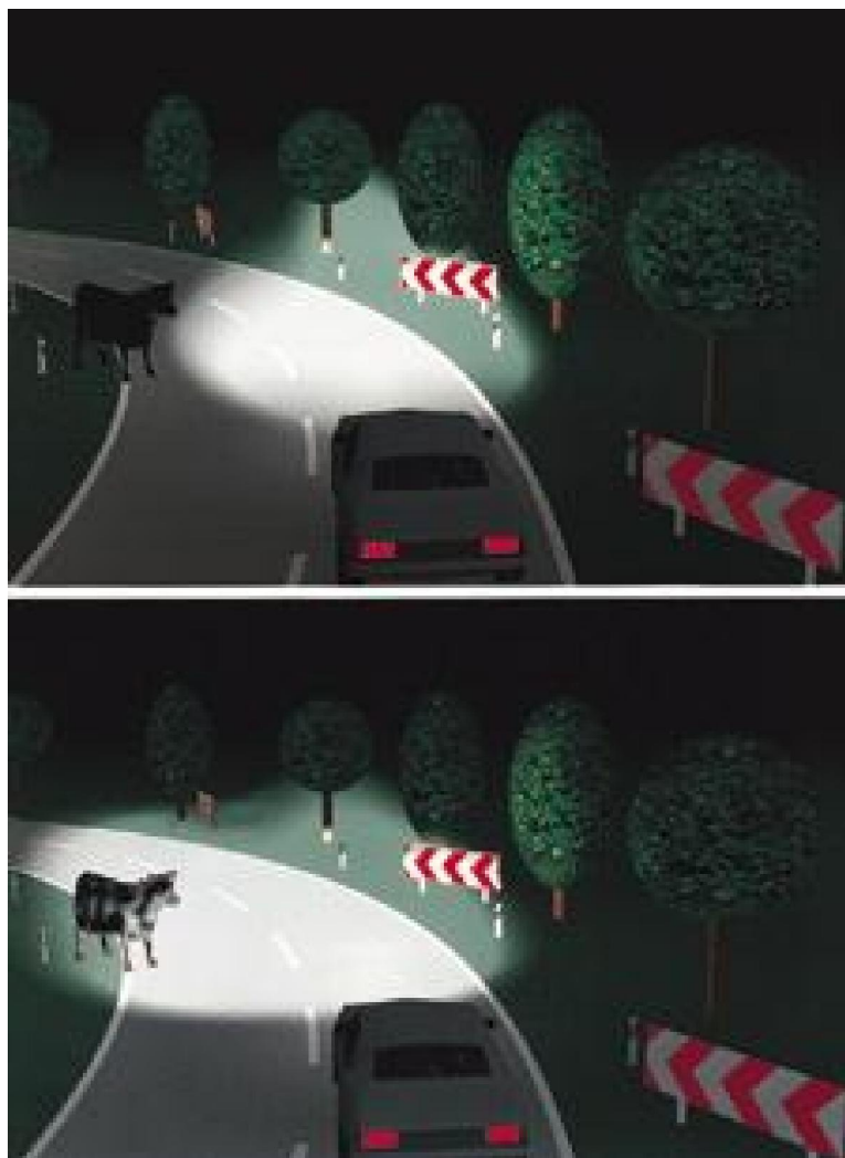
شکل ۸-۳) نور پردازی مسیر خمیده سیستم AFS و سیستم رایج
