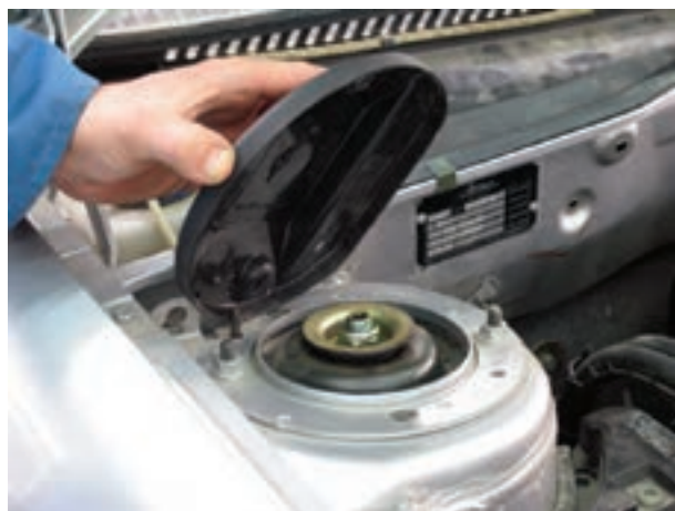
شکل ۳-۱۰۳- برداشتن پوشش بالای تکیه‌گاه کمک فنر
