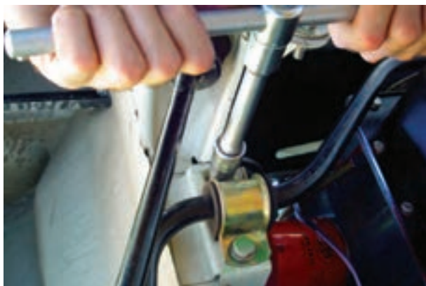
شکل ۳-۸۶- باز کردن میله ضد غلتش (موج گیر)
