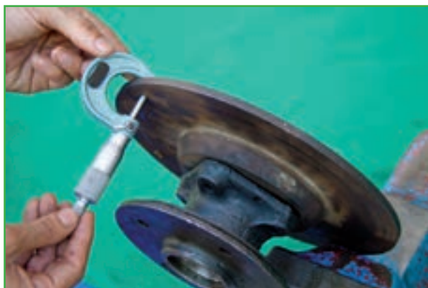
شکل ۱-۱۲۴- اندازه‌گیری ضخامت دیسک
