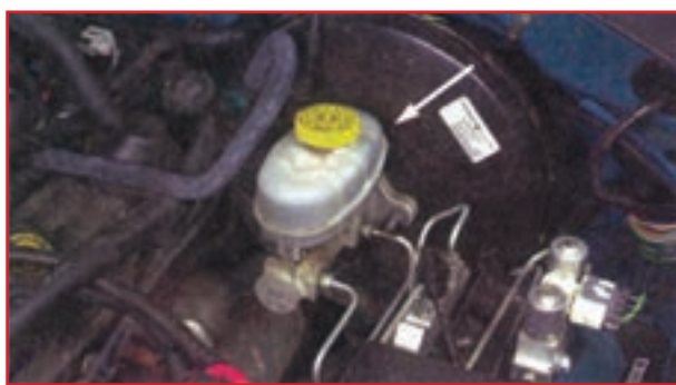
شکل ۱-۷۸- مخزن مایع ترمز و پمپ اصلی
