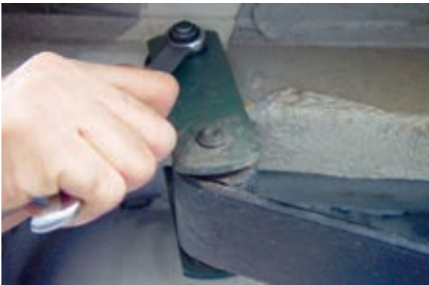
شکل ۳-۶۴ – باز کردن پیچ و مهره اتصال پایینی کمک فنر
