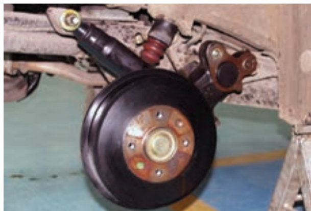
شکل ۳-۱۷۷- نصب کمک فنر
