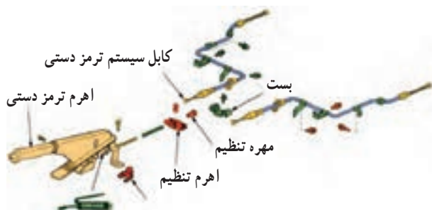
شکل ۱-۴۶- اجزای سیستم ترمز دستی
