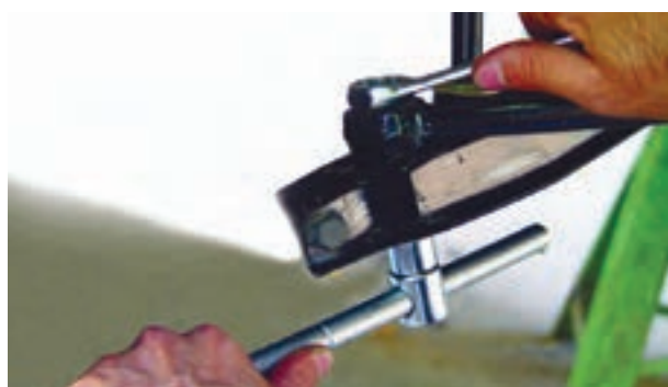
شکل ۳-۸۱ باز کردن میل تعادل از طبق
