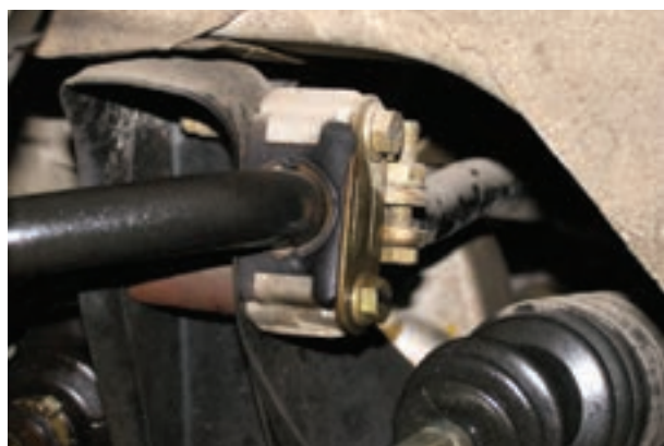
شکل ۱۳۲-۳- نصب بست‌های میل موج گیر بلند
