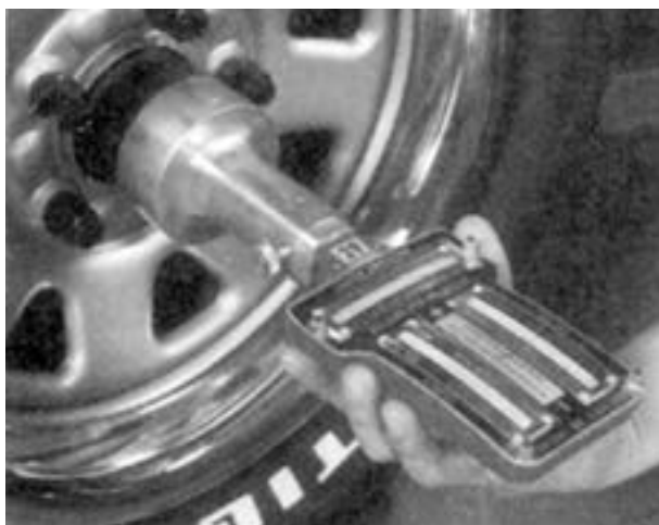
شکل ۲۱۷-۳- دستگاه اندازه‌گیری زوایای مکانیکی (ترازی)
