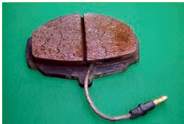
شکل ۱۱۲-۱- لنت ترمز دارای سیم هشدار
