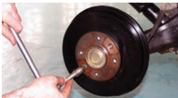
شکل ۱-۸۹ – باز کردن پیچ کاسه چرخ
