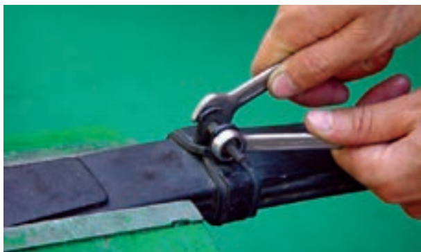
شکل ۳-۶۷- باز کردن بست‌های مجموعه فنر شمش
