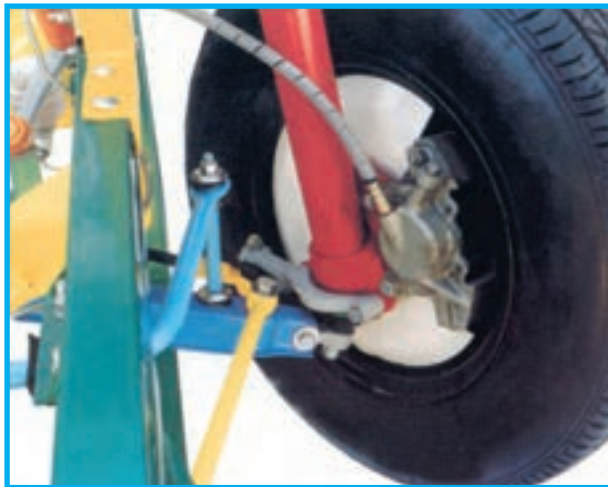
شکل ۱-۳۲- لوله مایع ترمز انعطاف پذیر
