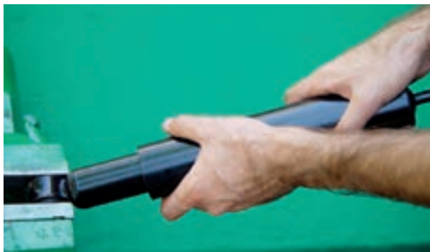
شکل ۳-۷۴- آزمایش کمک فنر
