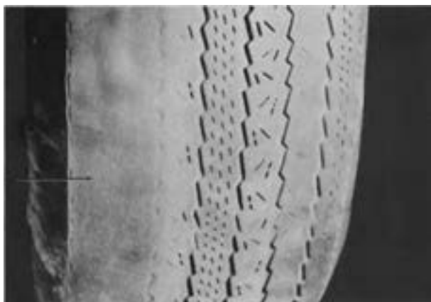
شکل ۲۱۵-۳- سایش در اثر کمبر نادرست
