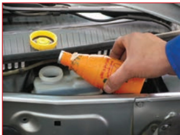
شکل ۱-۶۸- برکردن مخزن مایع ترمز تا حداکثر (MAX)
