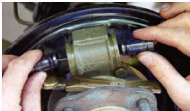
شکل ۹۴-۱- خارج کردن پیستون‌ها
