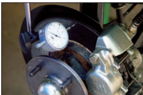
شکل ۱-۱۲۳- بررسی وضعیت دیسک
