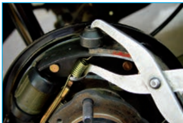
شکل ۹۱-۱- خارج کردن فنر بالایی
