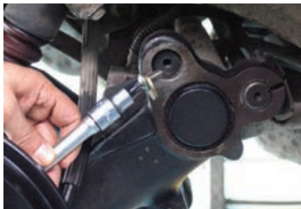
شکل ۳-۱۷۶- نصب واشر فشار و بیج‌های انتهایی میله‌ها
