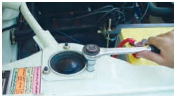
شکل ۳-۷۹ باز کردن مهره‌های اتصال تکیه‌گاه کمک فنر به بدنه خودرو
