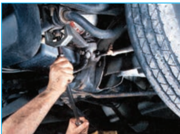
شکل ۴۷-۲- نحوه استفاده از نوعی سیبک کش
