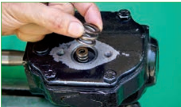
شکل ۲-۶۱- خارج کردن فنرها
