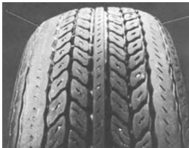
شکل ۲۱۴-۳- سایش در اثر رانندگی غلط (پیچیدن تند)
