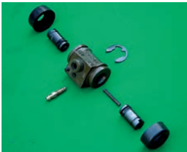
شکل ۹۵-۱- اجزای پمپ ترمز چرخ
