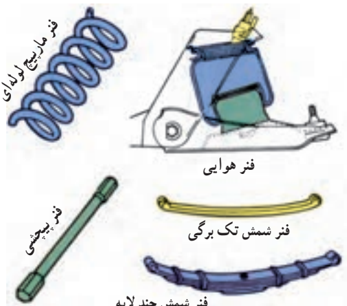
شکل ۳-۲۴ انواع فنرهای مورد استفاده در خودرو
