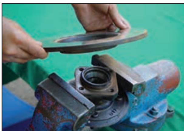
شکل ۱-۱۲۶- بازکردن دیسک ترمز
