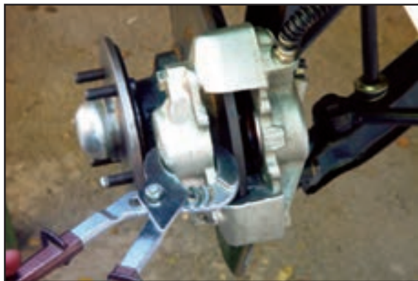
شکل ۱۱۴-۱- عقب راندن پیستون ترمز دیسکی
