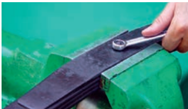
شکل ۳-۶۸- باز کردن پیچ مرکز فنرهای شمش
