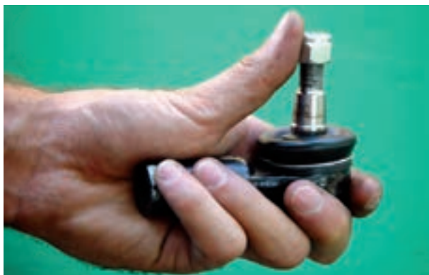
شکل ۸۴-۲- کنترل لقی سیبک‌ها
