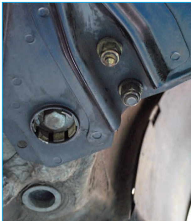
شکل ۱۳۰-۳- پیاده کردن میل موج گیر بلند
