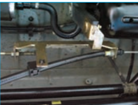
شکل ۱-۵۴- کابل‌های ترمز دستی
