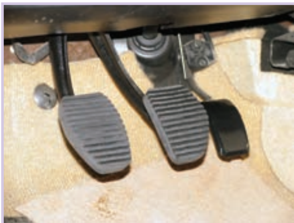
شکل ۱-۱۵ مجموعه پدال‌های ترمز و کلاچ
