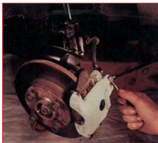
شکل ۱-۶۷- بیج هواگیری سیلندر چرخ
