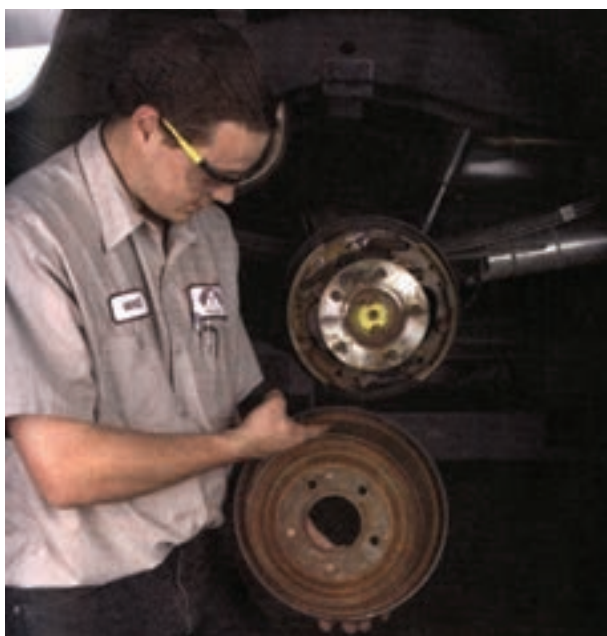
شکل ۹۶-۱- کنترل کاسه چرخ
