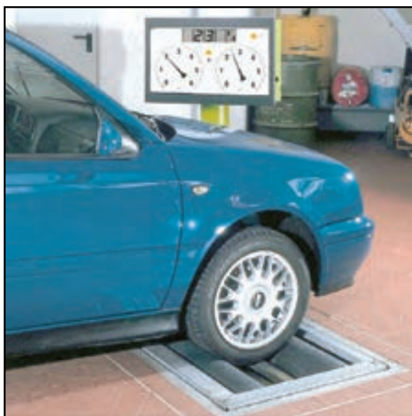
شکل ۱-۷۴- دستگاه آزمایش دینامیکی ترمز
