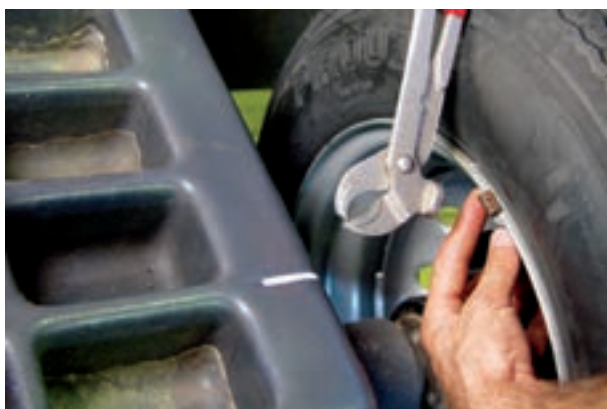
شکل ۲۳۹-۳- نصب وزنه روی قسمت داخلی رینگ
