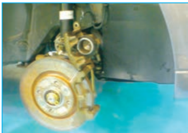
شکل ۱۱۰-۱- باز کردن پوسته نگاه‌دارنده لنت‌ها
