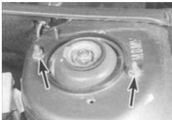
شکل ۱۱۹-۳- بستن پیچ‌های اتصال مجموعه به اتاق
