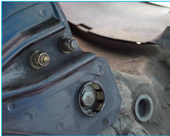
شکل ۳-۱۲۲- باز کردن پیچ های طبق
