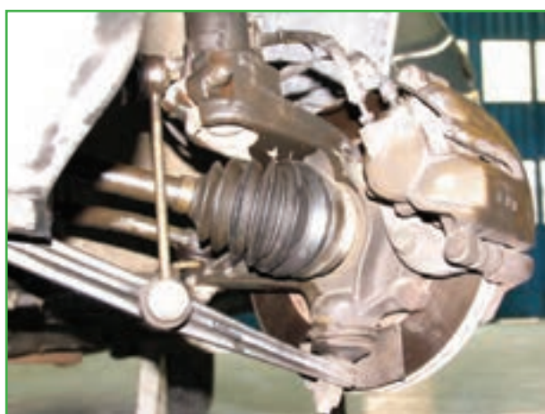
شکل ۳-۱۲۸- باز کردن پیچ‌های میل موج‌گیر
