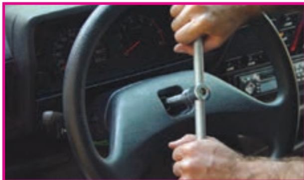
شکل ۲-۳۳- پیاده کردن فلکه فرمان
