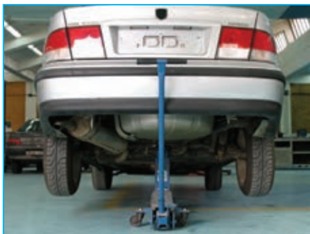
شکل ۳-۱۵۶- تنظیم ارتفاع و کنترل رام لوله‌ای
