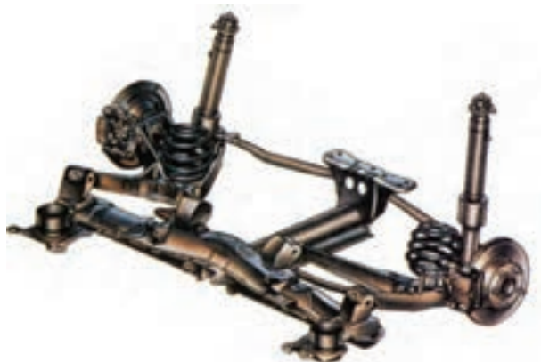
شکل ۳-۴۸- سیستم تعلیق مستقل عقب با چرخ‌های متحرک
