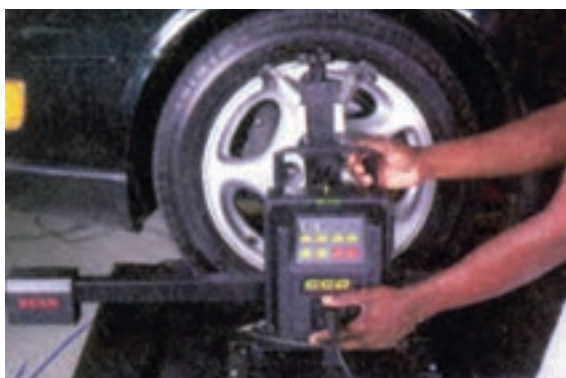
شکل ۳-۲۲۰ - نصب مجموعه حسگر دستگاه اندازه‌گیر رایانه‌ای
