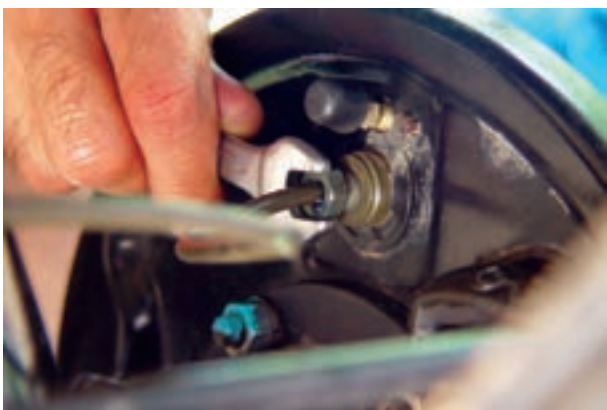
شکل ۱۰۵-۱- باز کردن مهره اتصال لوله ترمز
