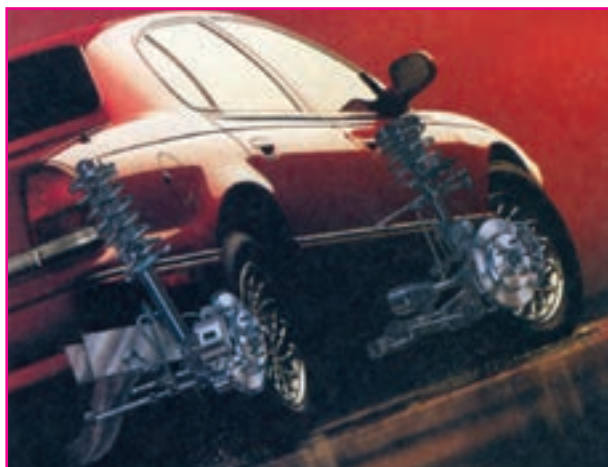
شکل ۱۰۹-۱- سیستم ترمز دیسکی در چرخ‌های جلو و عقب
