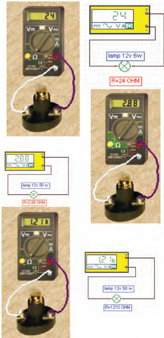
شکل ۸۹-۲- اندازه گیری مقاومت لامپ های روشنایی
