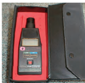
دورسنج دیجیتالی با محرک مکانیکی
