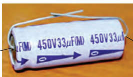
الف - توجه به قطب‌های خازن الکترولیتی
