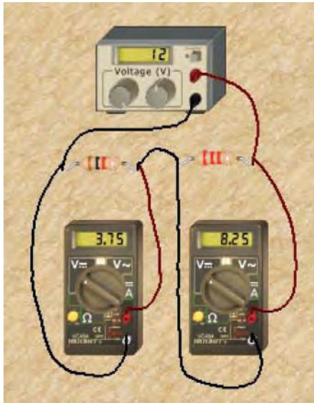
شکل ۹۳-۲ اندازه گیری ولتاژ دو سر مقاومت ها به صورت سری
