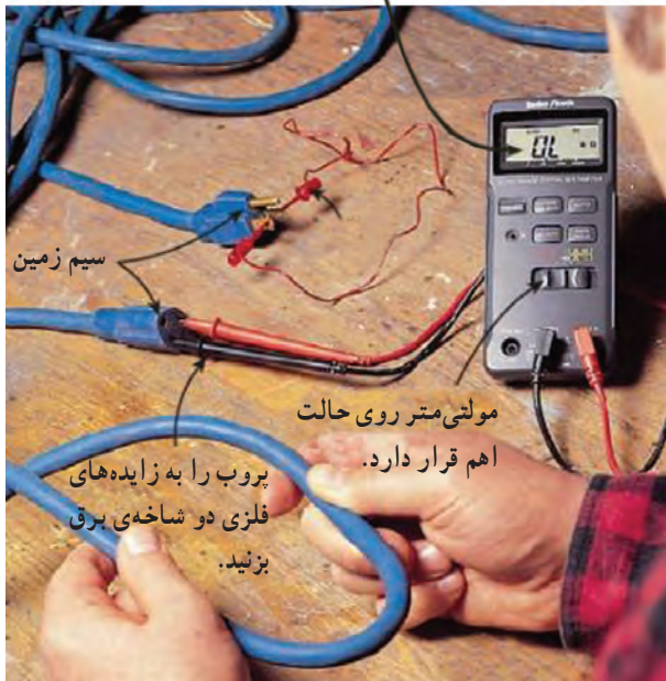
شکل ۲-۸۰ - آزمایش سیم رابط برق دستگاه.
