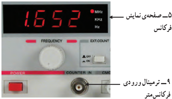
شکل ۲-۱۰۳- فرکانس متر و ترمینال ورودی آن
