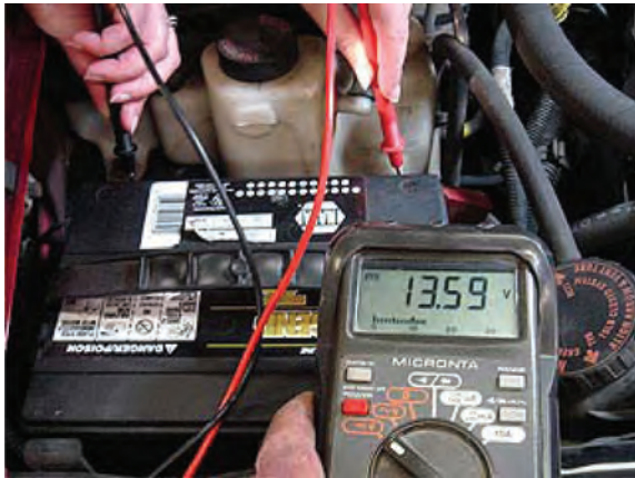
شکل ۱-۵۰ اندازه‌گیری ولتاژ با ولت‌متر دیجیتال
