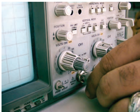
شکل ۱۱۴-۲ نحوه‌ی اتصال BNC به اسیلوسکوپ
