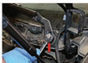
۵- پوشش پلاستیکی روی بازوی برف پاک‌کن را برداشته و با آچار مناسب مهره آن را باز کنید.
