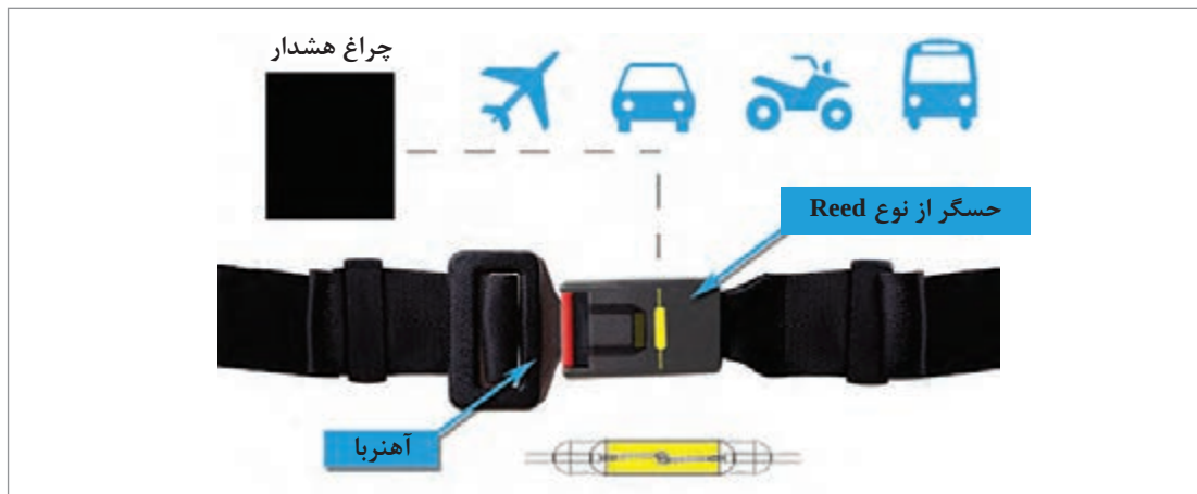
شکل ۲۳- عملکرد reed switch در کمر بند ایمنی
