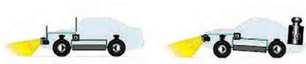
شکل ۹- دلیل نیاز به سیستم تنظیم ارتفاع چراغ
