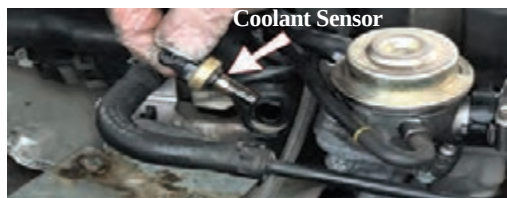
شکل ۱۳- حسگر دمای مایع خنک کننده موتور و محل بستن آن روی موتور
