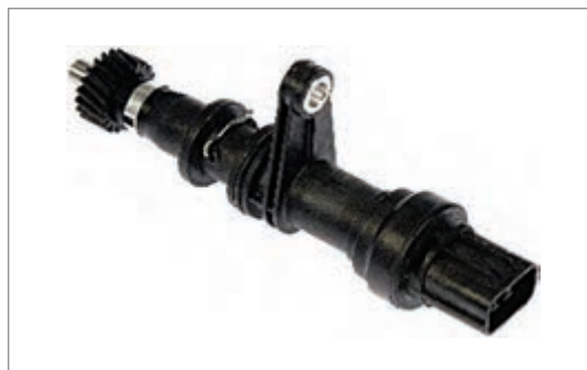
شکل ۱۶- حسگر سرعت خودرو از نوع القایی
