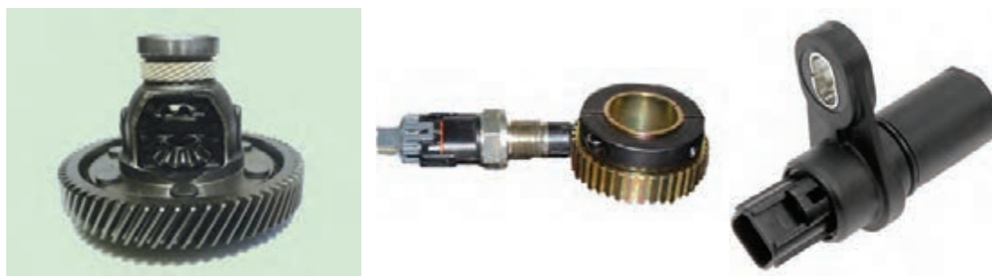
شکل ۵۸- حسگر و چرخ دنده بسته شده روی دیفرانسیل
