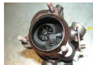
شکل ۸۳- نشت روغن در توربوشارژر
