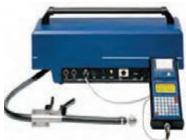
شکل ۵۹- دستگاه تست کدري دود خودروهای ديزلی
