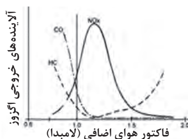
شکل ۷- تأثیر نسبت هوا به سوخت روی سه آلاینده مهم
