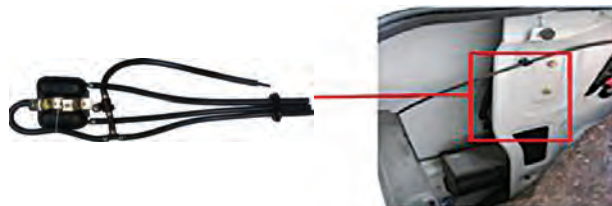
شکل ۴۶- بررسی مجموعه حباب گیر
