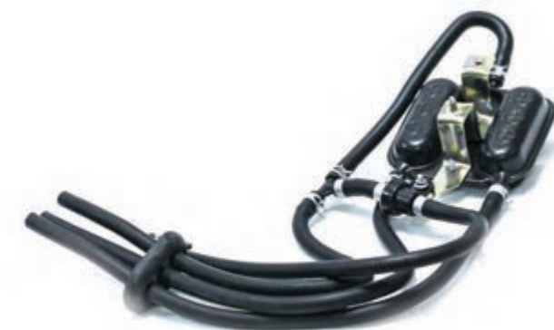
شکل ۶- ساختمان سیستم حباب گیر بنزین
