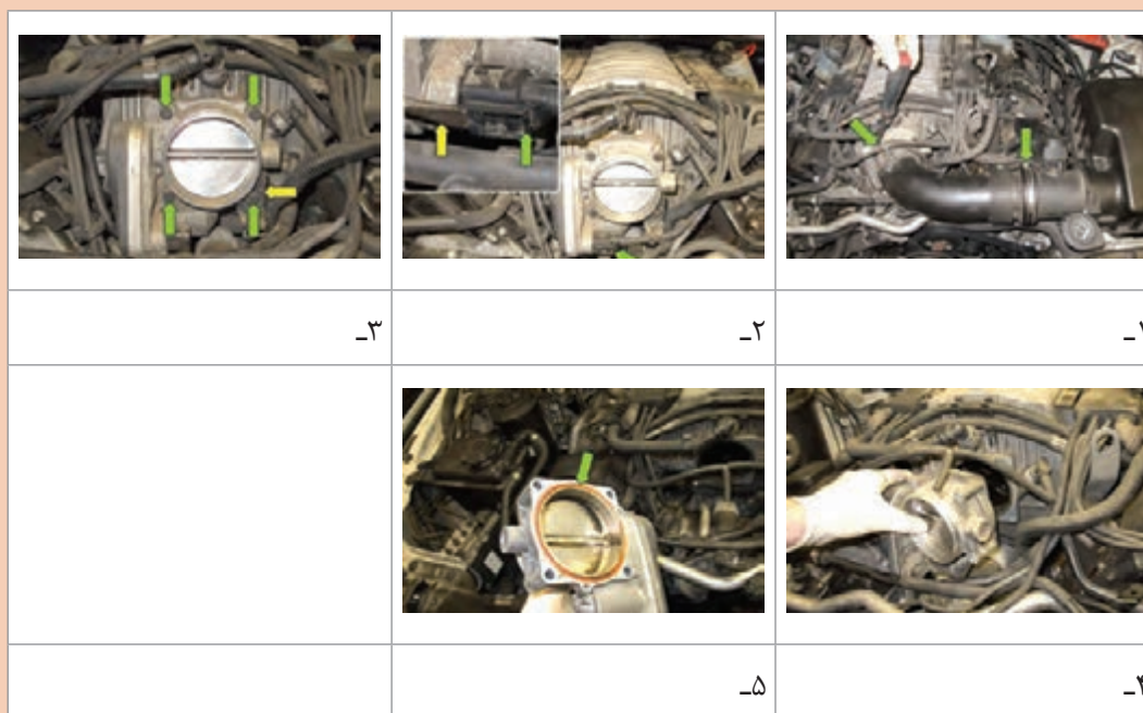
شکل ۸۲- مراحل تعویض یک نوع دریچه گاز
