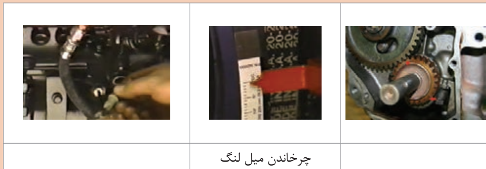
شکل ۶۲- دستگاه آزمایش و تنظیم یک نوع پمپ انژکتور ردیفی
