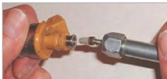
شکل ۷۹- تعویض فیلتر انژکتور
