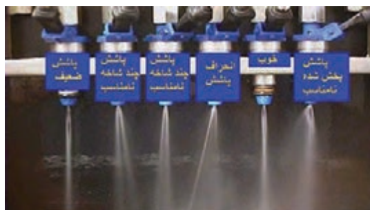
شکل ۷۷-انواع احتمالی پاشش سوخت در انژکتور
