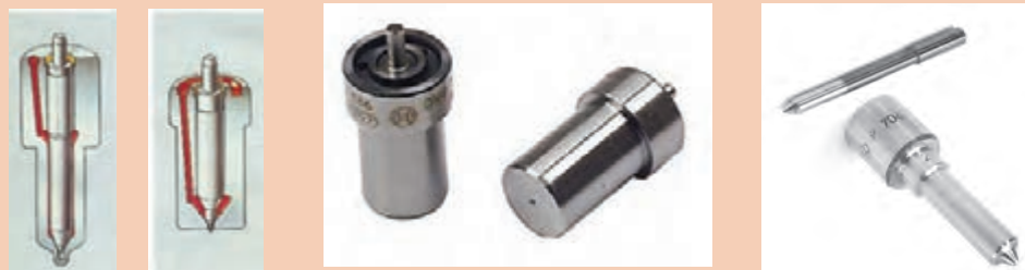
شکل ۴۸- نازل سوراخ دار و زباندار
