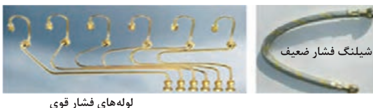
شکل ۳۶- لوله‌ها و شیلنگ‌های انتقال فشار قوی و ضعیف در سوخت‌رسانی دیزل
