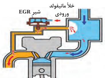
شکل ۱۹- مسیر عبور گازهای خروجی خلای
