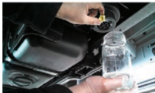
شکل ۵۴ - روش تخلیه آب موجود در فیلتر سوخت دیزل
