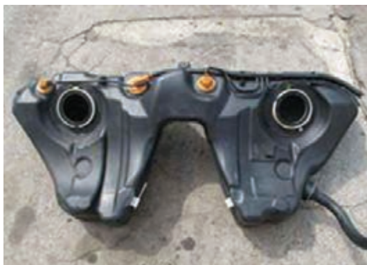
شکل ۷- مخزن سوخت با سوپاپ واژگونی
