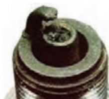
شکل ۳- آسیب به شمع بر اثر خودسوزی
