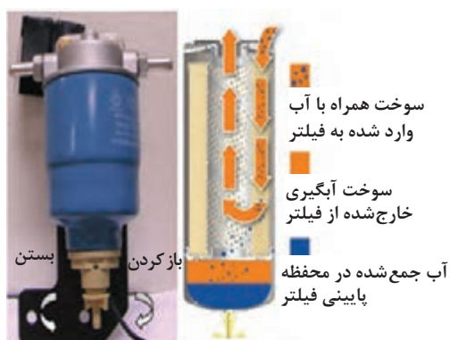
شکل ۵۵ - فیلتر اولیه سوخت دیزل با پیچ تخلیه آب
