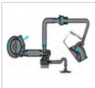
پمپ تزریق ثانویه اسماگ
