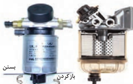
شکل ۵۴ - روش تخلیه آب موجود در فیلتر سوخت دیزل
