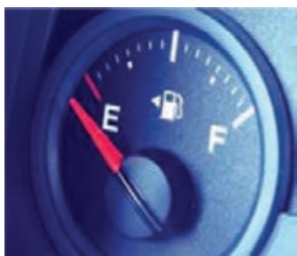
شکل ۱۷- نمایشگر سوخت آنالوگ (عقربه‌ای)
