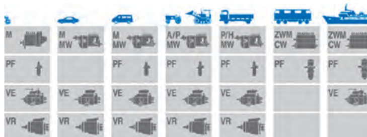
شکل ۹- کاربرد انواع پمپ‌های انژکتور مکانیکی بوش در وسایل نقلیه دیزلی
