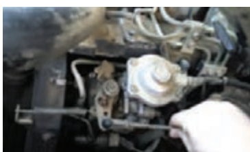
شکل ۵۹ - بازدید، بررسی و تنظیم اهرم‌بندی گاز و خاموش کن
