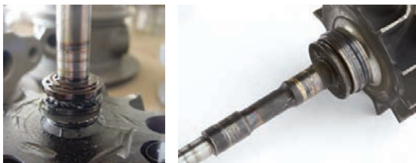
شکل ۸۵- خرابی یاتاقان ها و محور توربوشارژر
