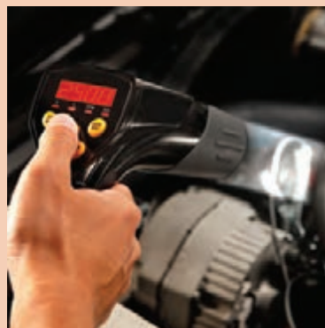
شکل ۲۱- روش کاربری چراغ تایمینگ
