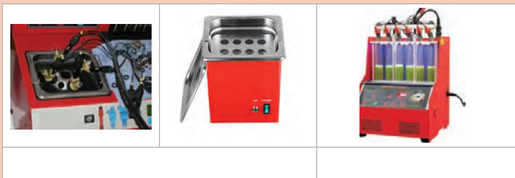
شکل ۷۸- دستگاه شست و شوی انژکتور
