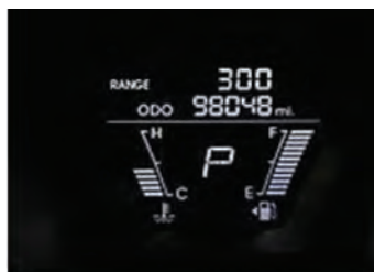
شکل ۱۸- نمایشگر سوخت دیجیتالی (میله‌ای)
