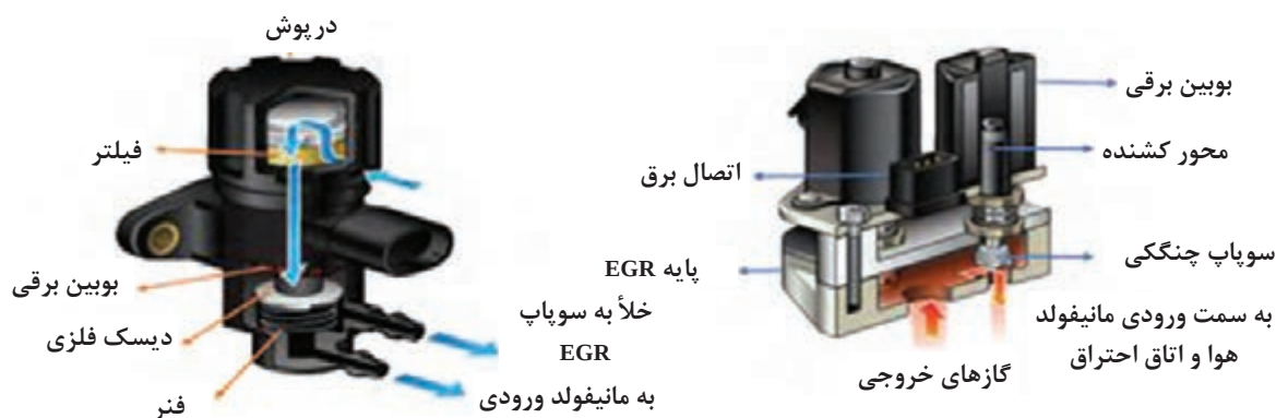
شکل ۱۶- شیر برقی EGR مدل بیرونی و داخلی
