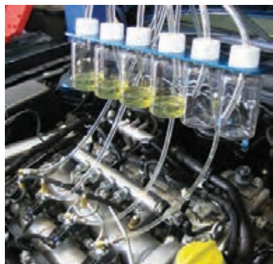
شکل ۵۵- تست اندازه‌گیری مقدار سوخت برگشتی انژکتورها
