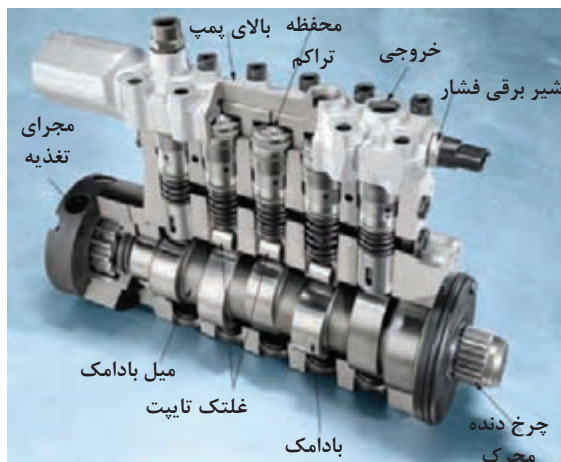
شکل ۲- یک نمونه پمپ انژکتور ردیفی
