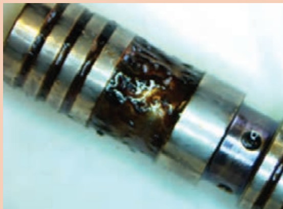
شکل ۷۶- خرابی انژکتور در اثر آب در سوخت
