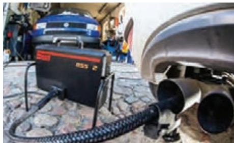
شکل ۵۸- قراردادن لوله دستگاه کنترل آلايندگی درون لوله اگزوز
