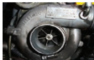
شکل ۸۳- نشت روغن در توربوشارژر
