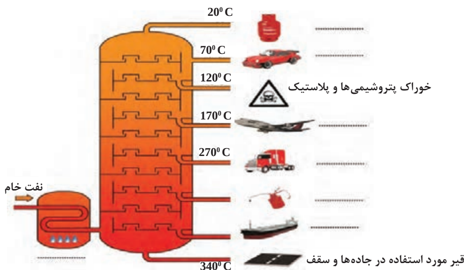
شکل ۵- نمای ساده‌ای از برج تقطیر در پالایشگاه
