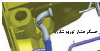
شکل ۳۲- موقعیت حسگر فشار توربو شارژر
