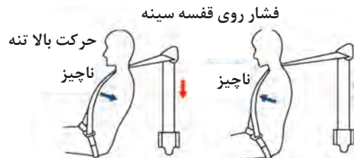
شکل ۵۲- عملکرد کمربند ایمنی برای حفاظت از سرنشین در برخورد از جلو
