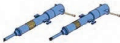
ستون فرمان لوله مشبک
