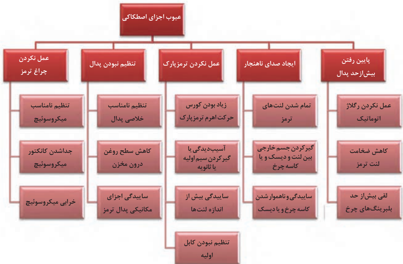
شکل ۲۳- عیوب اجزای اصطکاکی
