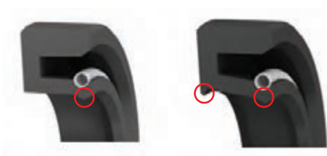
شکل ۷- نمای برش خورده کاسه‌نمد یک لبه و دو لبه
