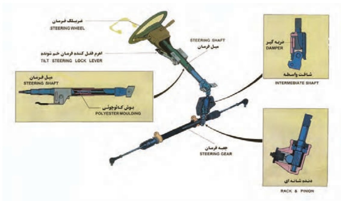
شکل ۲ - مجموعه فرمان و اجزای آن
