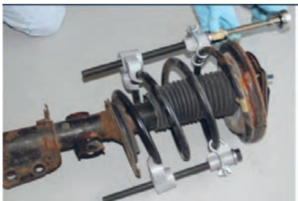
شکل ۳۵- برخی نکات باز کردن سیستم تعلیق مک فرسون
