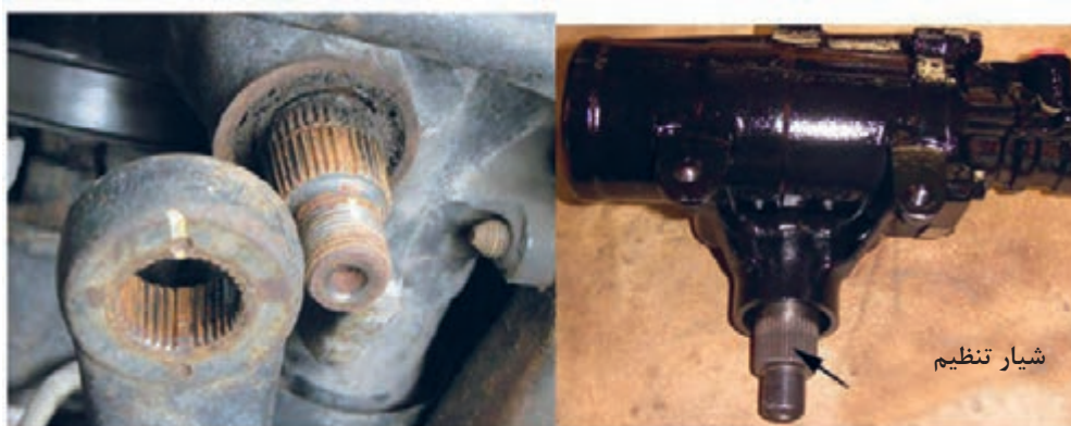
شکل ۳۲ - هزار خار محور خروجی جعبه فرمان
