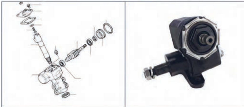
شکل ۲۹ - نوعی مکانیزم تنظیم لقی طولی ماریج فرمان
