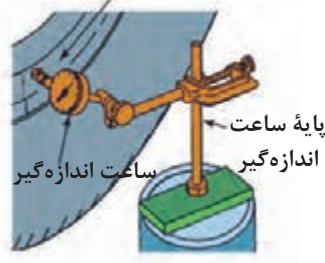
شکل ۱۸- کنترل تغییر شکل تایر و رینگ
