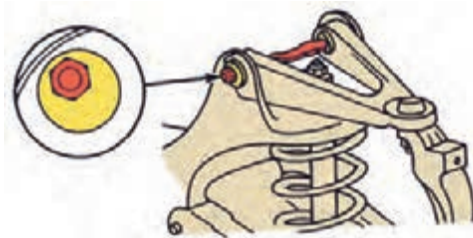
شکل ۳۹- مجموعه تعلیق طبق دار دوبل و روش تنظیم زوایا
