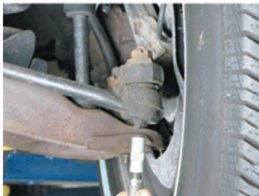
شکل ۳۳ - روش گریس کاری سیبک
