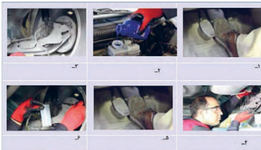
شکل ۱۹- مراحل هواگیری دستی مدار هیدرولیک ترمز
