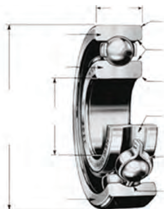
شکل ۵- ساختمان و اجزای بلبرینگ
