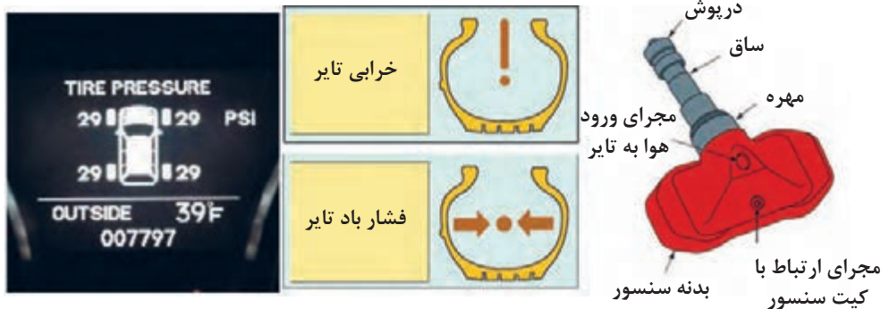
شکل ۱۴- حسگر فشار باد تایر و چراغ هشدار مربوطه در صفحه نشان دهنده‌ها
