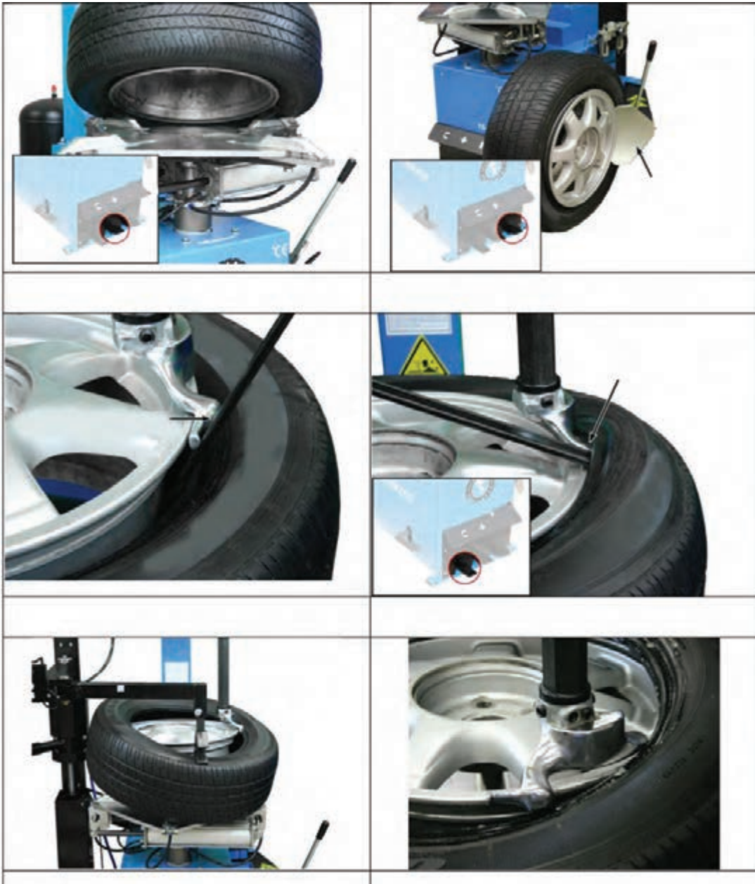
شکل ۳۴- مراحل استفاده از دستگاه لاستیک در آر پنوماتیکی
