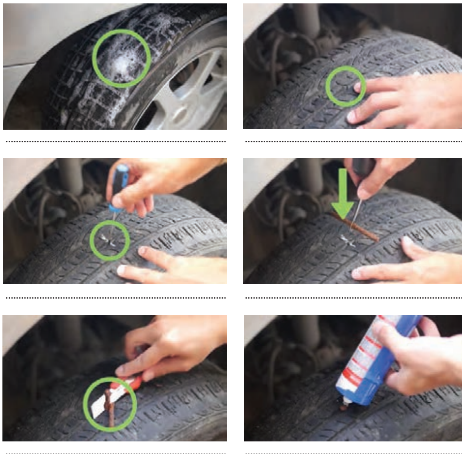
شکل ۲۷- مراحل پنچرگیری تایر بدون تیوب
