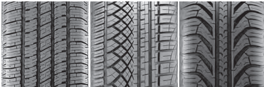
شکل ۶- انواع متداول آج تایر ۱- آج جهت دار ۲- آج متقارن ۳- آج نامتقارن
