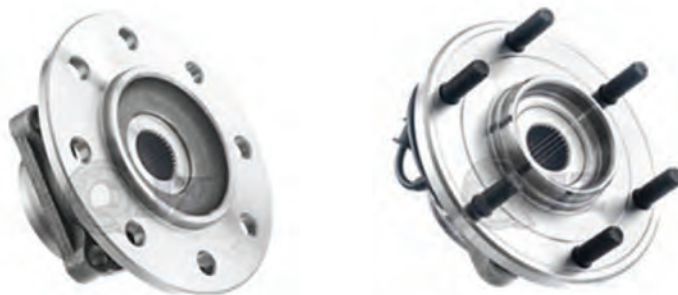
شکل ۲۷- توپی از نظر استفاده از پیچ یا مهره
