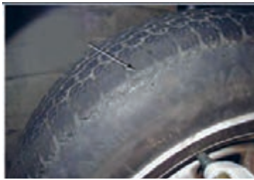
بررسی ظاهری تایر از نظر ساییدگی (شکل تکمیلی)
