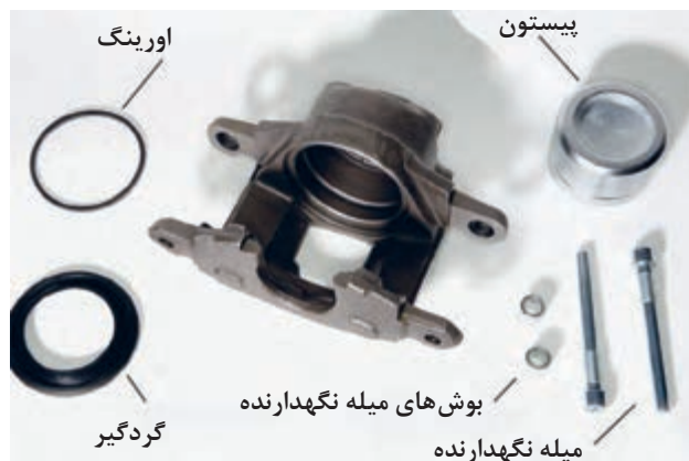
شکل ۳۶- اجزای مجموعه هیدرولیکی کالیپر ترمز
