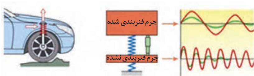
شکل ۲۶- عملکرد سیستم فنربندی تعلیق
