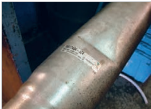
شکل ۱۵-۳- مشاهده آثار ضربه روی سطح میل گاردان
