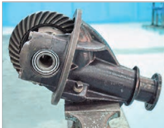
شکل ۴-۲۷- بستن مجموعه دیفرانسیل روی گیره
