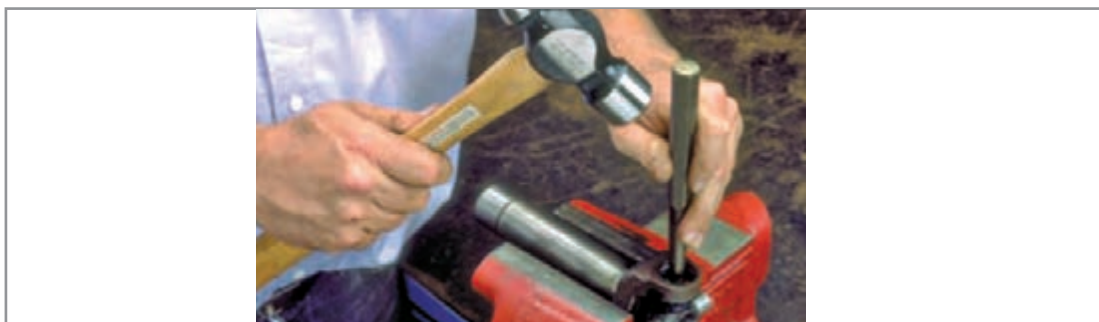
شکل ۲۱-۳- مراحل باز کردن اجزای گاردان
