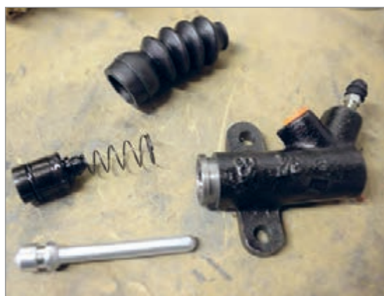
شکل ۱-۲۴- اجزای سیلندر اصلی کلاچ
