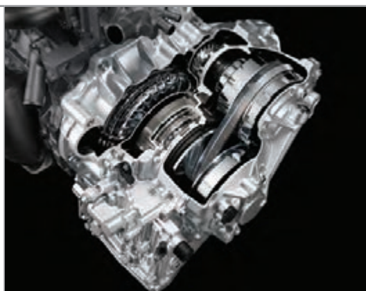
جعبه دنده اتوماتیک - CVT
