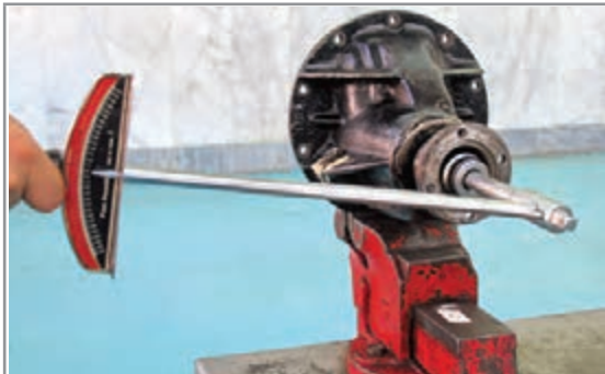
شکل ۴۸-۴-ب تعیین گشتاور پیش بار با گشتاورسنج
