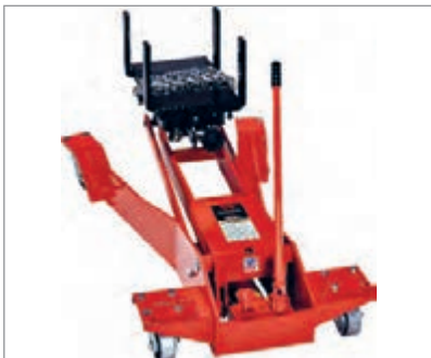
شکل ۲۷-۲ انواع جک نگهدارنده جعبه‌دنده
