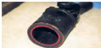
شکل ۱۱-۳- مقطع گاردان دو لایه با لایه لاستیک میانی
