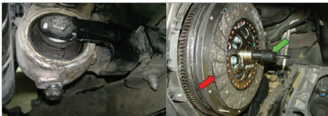
بررسی دسته نگهدارنده جعبه‌دنده
