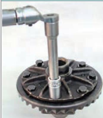
شکل ۵۰-۴- بستن پیچ‌های کرانویل
