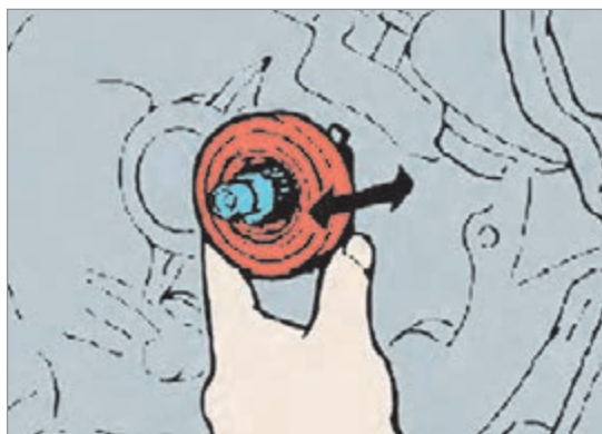
شکل ۴۰-۱ نحوه بررسی حرکت بلبرینگ کلاچ روی شفت کلاچ
