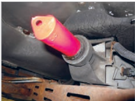
شکل ۳-۱۹- استفاده از ابزار مخصوص کورکن
