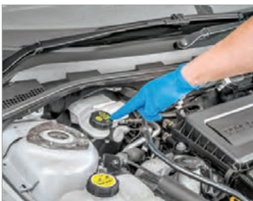
شکل ۱۶-۱- مخزن مایع مشترک در یک خودرو
