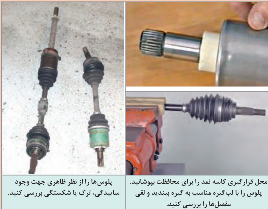
شکل ۲۰-۵ - نکات مورد توجه هنگام بررسی پلوس‌ها
