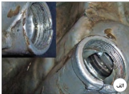
شکل ۲-۳۴- پوسته جعبه‌دنده و نحوه ترمیم آن
