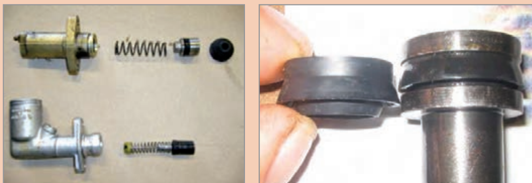
شکل ۲۱-۱- الف) نشتی داخلی در مدار هیدرولیکی
