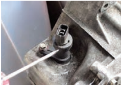
شکل ۲۶-۲ روش تعویض میکروسوییچ دنده عقب و حسگر سرعت
