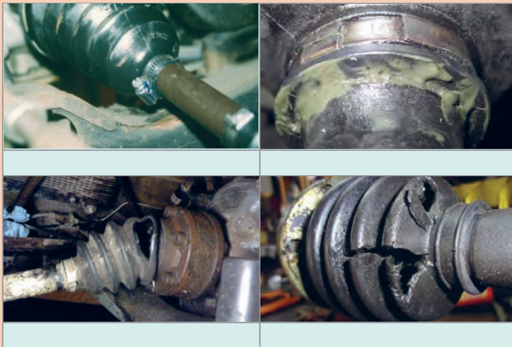
شکل ۱۷-۵- روش بررسی ظاهری پلوس‌ها
