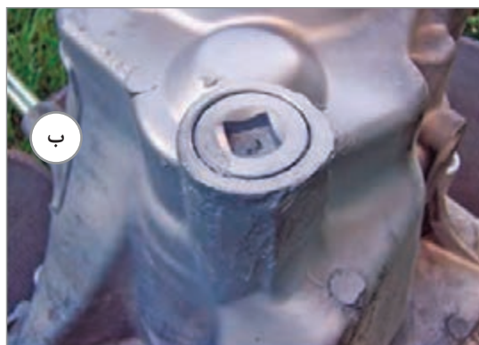
شکل ۲-۳۴- پوسته جعبه‌دنده و نحوه ترمیم آن
