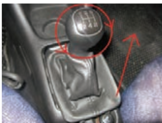
شکل ۲-۲۵- خارج کردن سری و گردگیر دسته دنده
