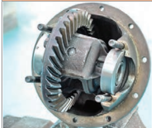
شکل ۵۲-۴- استفاده از رولبرینگ آزمایشی
