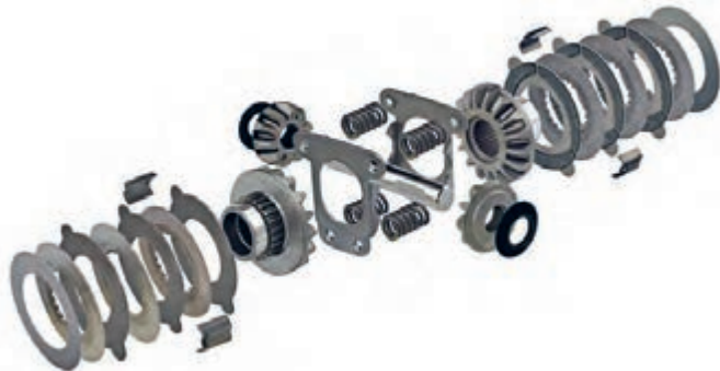
شکل ۴-۴ اجزای دیفرانسیل ضد لغزش
