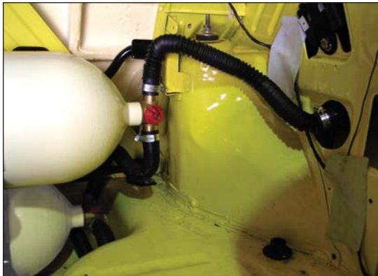
شیر سماوری و فیوز حساس به فشار
