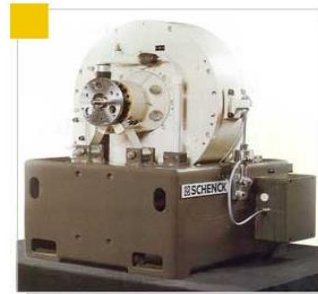
دینامومتر از نوع ادی کارنت با قدرت ۱۳۰ کیلو وات در شرکت ایران خودرو
