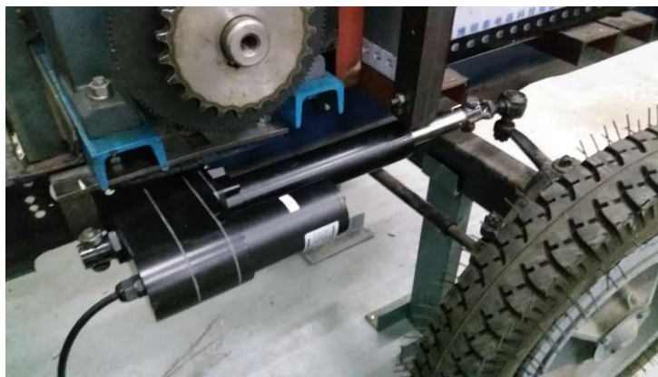
شکل (۲-۱۸) سیستم فرمان سیمی با محرک خطی مورد استفاده در تراکتور
