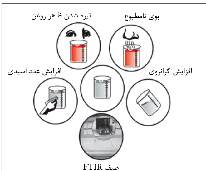
شکل ۴. تشخیص گرم شدن بیش از حد روغن
